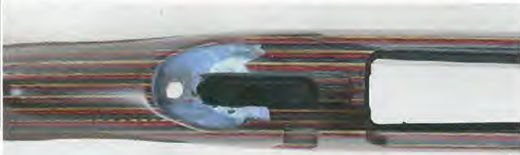
GLEICHBLEIBEND Der Schaft ist aus steifem, sich auch bei Temperatur- und Luftfeuchtigkeitsänderungen nicht verziehendem Schichtholz gefertigt, sodass der Lauf immer frei schwingt.
