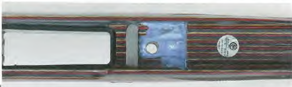
GUT GEBETTET An der vorderen und hinteren Systemschraube ist die Hülse der JPR-1 Kodiak in Kunstharz gebettet. Zudem ist vor dem Magazinschacht ein Rückstoßlager eingelassen.
